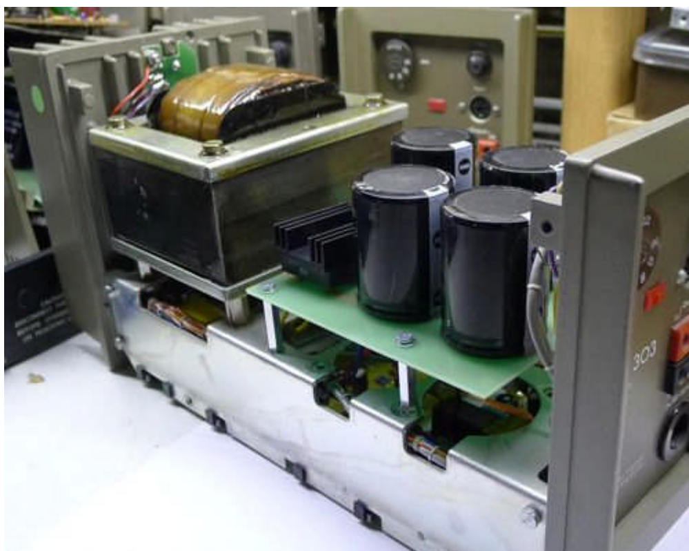
303 シャーシ上の電源ユニット
