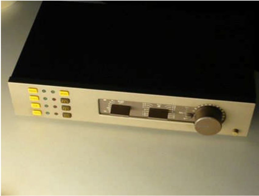
QUAD 34 再生後、全面パネル部
